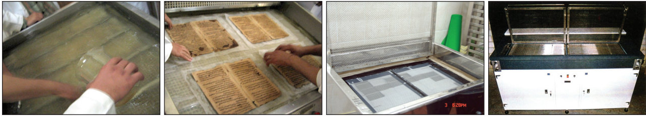
أ- ماكينة سد الثقوب ب- تجهيز سطح الماكينة حسب مساحة الأوراق ج- وضع الأوراق على سطح الماكينة د- رفع الماء وصب اللب بالكمية المناسبة لعدد الثقوب فى الصفحات
