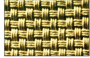
الشكل ٣: التركيب النسجي لنسيج المبرد ٣/٣.
