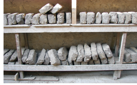
اللوحة ٢٨: طريقة تخزين قوالب الطيني والمونة وطبقات الملاط (اللياسة)
