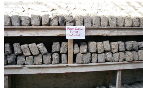
اللوحة ٢٧: طريقة تخزين قوالب الطيني طبقاً لموقع كل مدماك في الجدار (الجدار الشرقي)
