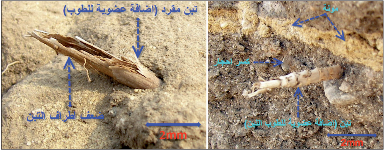
اللوحة ٤: يوضح الإضافات العضوية للطوب الطيني (التبن المقصوص).
