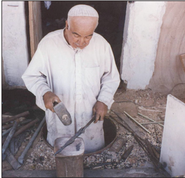
اللوحة ٨: حدّاد تقليدي يقف في حفرة منخفضة على مستوى قريب من السندان، دون الحاجة إلى أن يحني ظهره.
