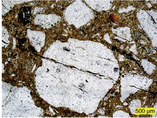
الشكل ٩: أ، ب: صورة بالمجهر الضوئي توضح مظاهر ضعف وتلف الطوب اللبن الداخلية: (أ)، وتجمعات طينية متجانسة، (ب) شروخ بطول العينة.
